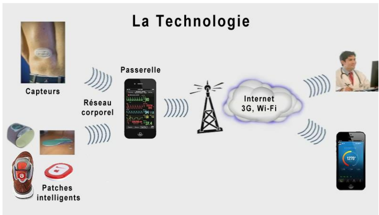
FIGURE I.1 UN SYSTEME DE BIO-TELEMETRIE NUMERIQUE SANS FIL QUI SURVEILLE LES SIGNES VITAUX A L'AIDE D'UN TELEPHONE INTELLIGENT.
