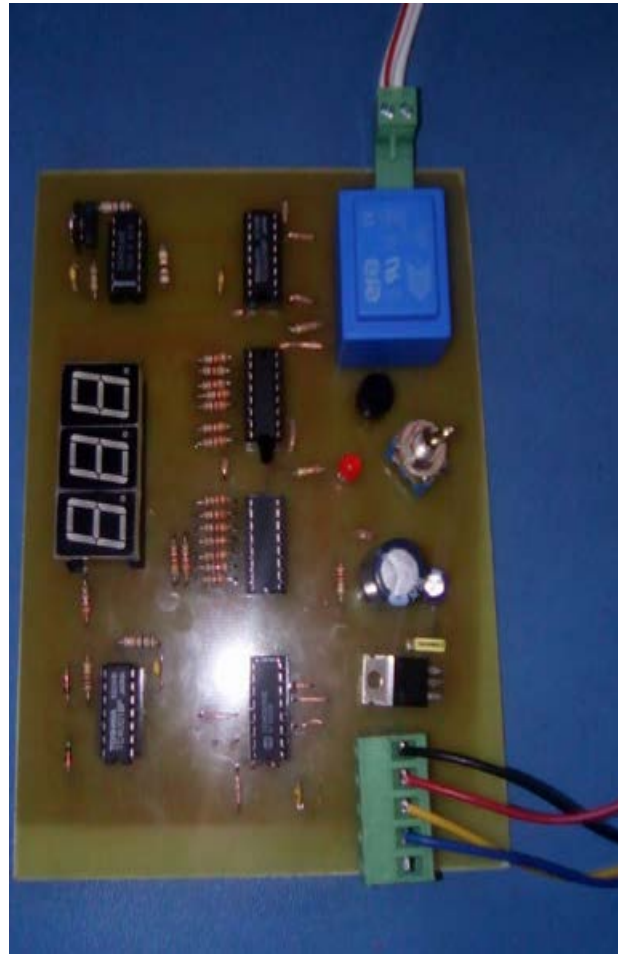
Figure 3.15: photo de circuit réalisé de l’affichage et l’alimentation
