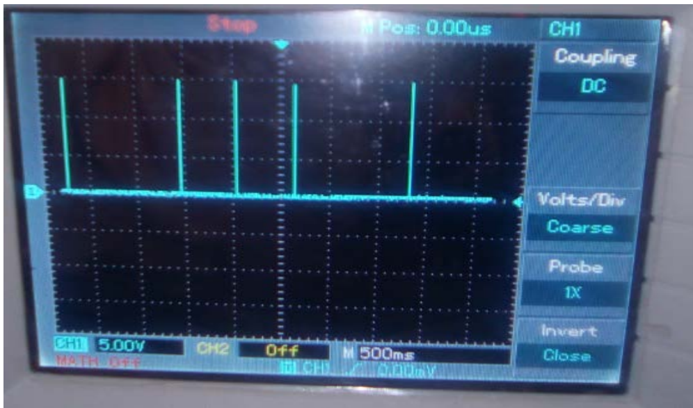
Figure 3.18: Point L : la sortie de la bascule RS
