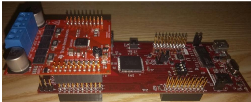
Figure 4-1 : Connexion du BOOSTXL-DRV8305 (en haut) à la LAUNCHXL-F28069M (en bas)
