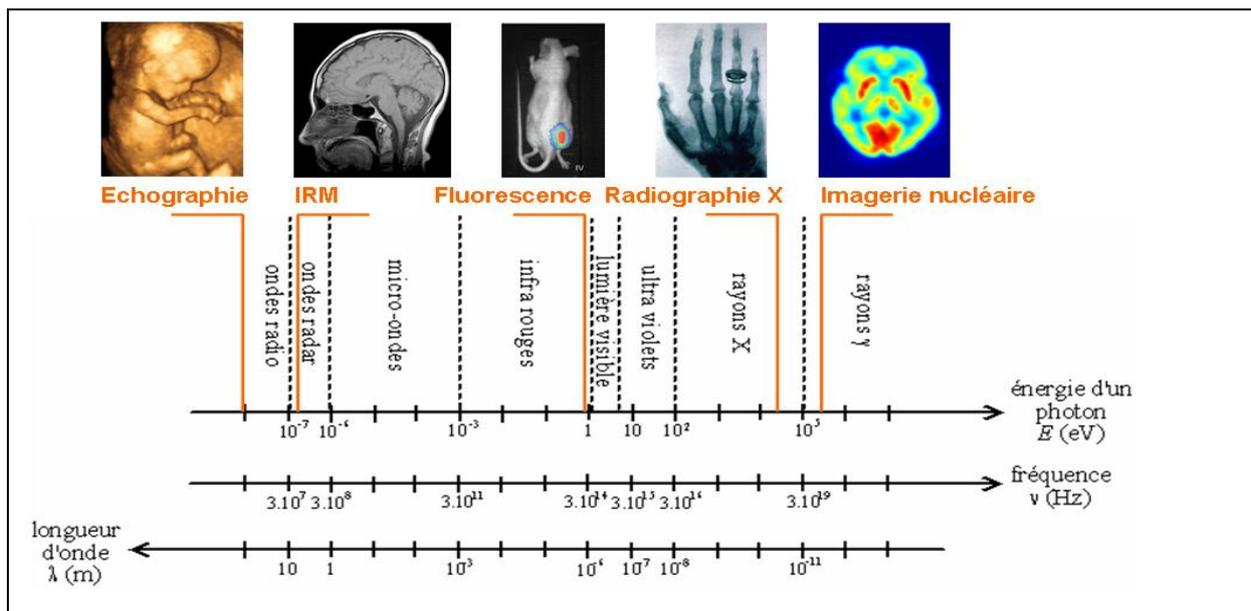
Figure 1.2 : Les différentes modalités d'imagerie en fonction des ondes électromagnétiques
