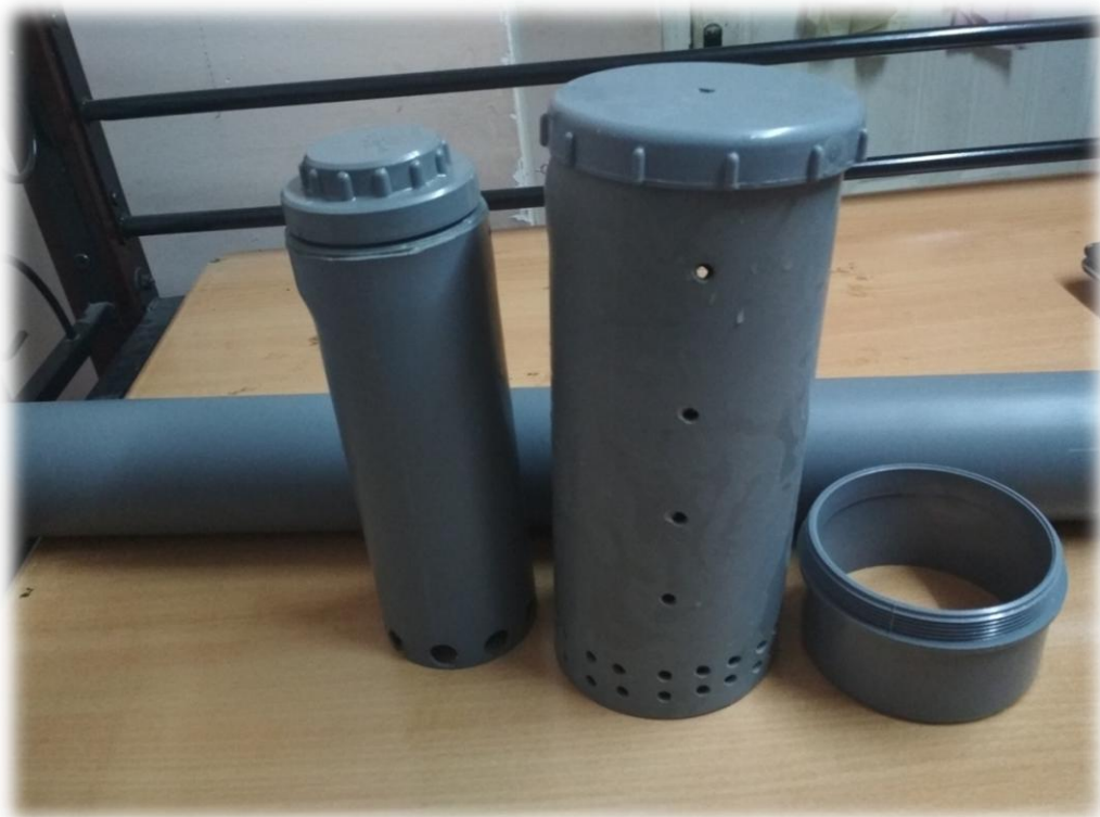
Figure 2.8 : Le siphon de notre système
