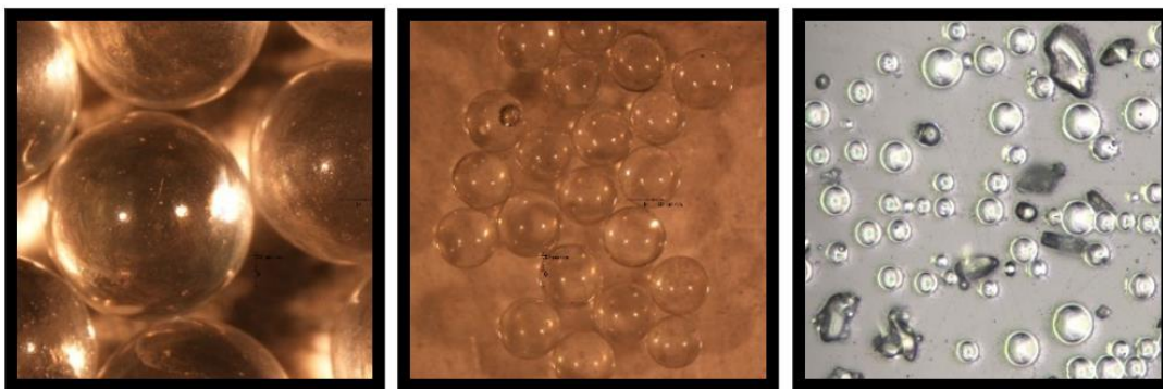
Figure 5.9 : Échantillons de billes de verre : 4 mm, 1 mm et 45 \mu\text{m}
