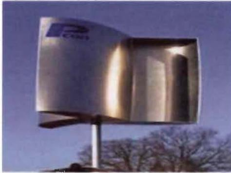
Figure 2-8 Éolienne à axe vertical
