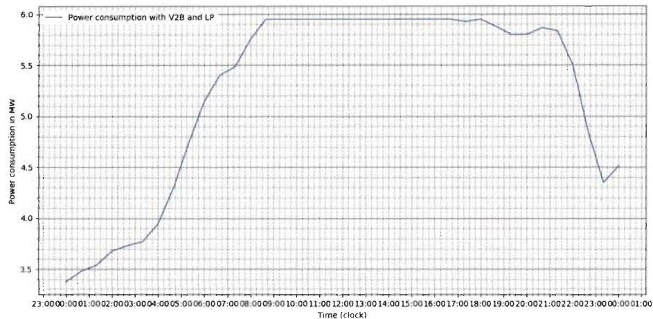
Figure 5-33 : Réduction du pic de puissance, 23 février 2015
