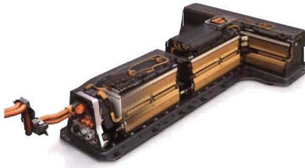
Figure 2-17 : Pack batterie d'une Chevrolet Bolt [44].
