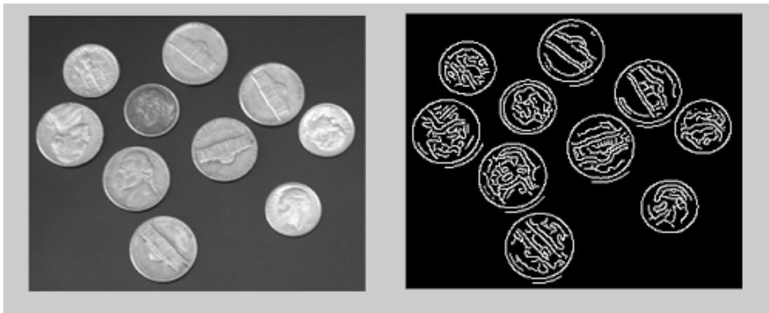
**Figure 2.6 : Application d'un filtre de détection de bord comme noyau de convolution sur une image numérique**
